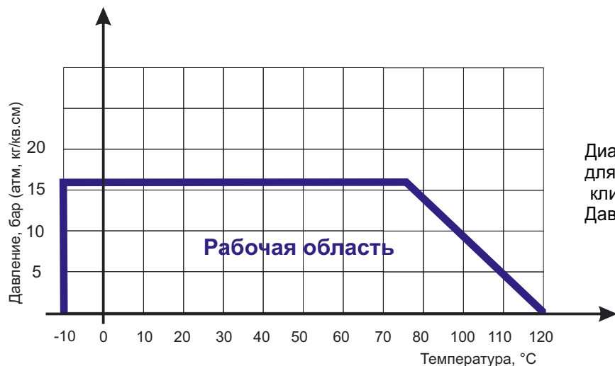
Диаграмма Давление / Температура для задвижки клиновой ABRA-A40-16G с обрезиненным клином и невыемным штоком Ду40-600 Ру16:
