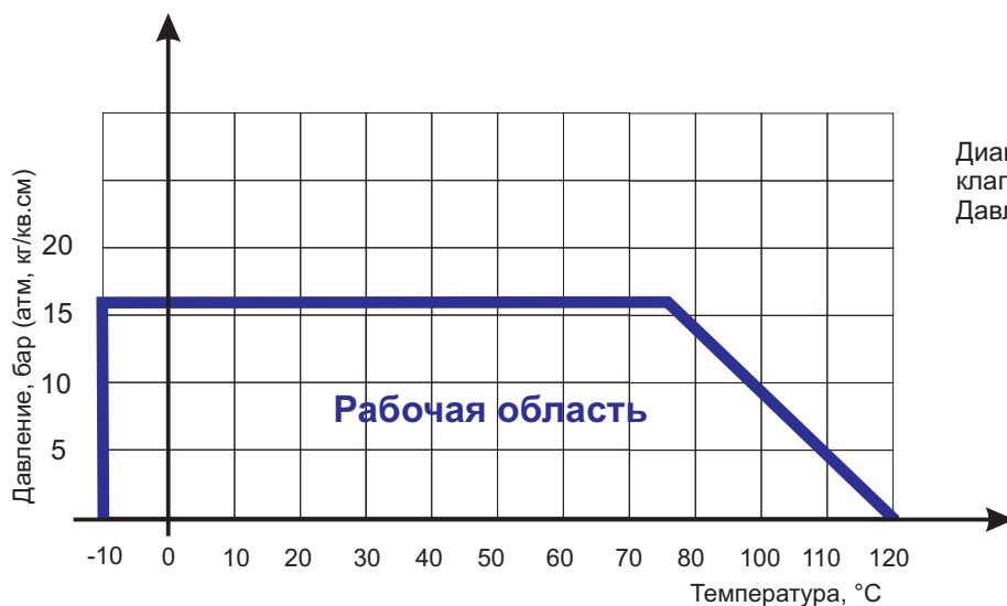
Диаграмма Давление / Температура для клапана обратного ABRA-D-122
